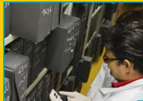
Si l'hygrométrie est assurée par la climatisation, les agents la surveillent tout de même à l'aide d'un appareil de mesure.
